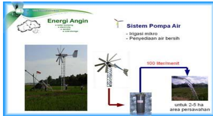
Gambar 2. Mekanisme Tenaga angin memompa air
