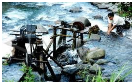
Gambar 3. Kincir air penggerak turbin
